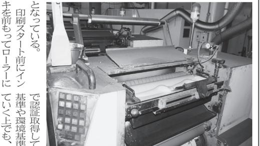
分割されたダクターローラーがインキつぼに接触する長さを制御することによりインキを供給(=IPCシステム)
